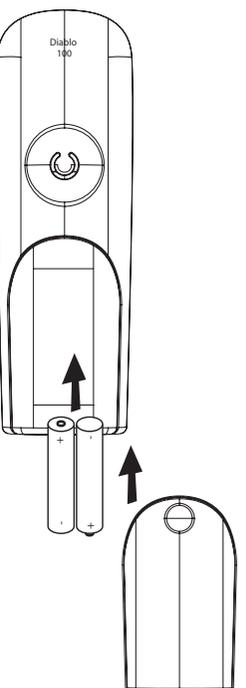
Stellen Sie das Mobilteil in die Basisstation. Die rote Lade-LED leuchtet, solange sich das Mobilteil auf der Basisstation befindet. Laden Sie das Mobilteil 24 Stunden lang, bevor Sie das Mobilteil zum ersten Mal verwenden. Um die Lebensdauer der Batterie zu verlängern, sollten Sie die Batterien ab und zu vollständig entladen. Wenn das Mobilteil einen Warnton aussendet oder wenn das Batteriesymbol leer angezeigt wird, müssen Sie das Mobilteil wieder zum Laden auf die Basisstation stellen.
